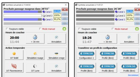
Une fenêtre **Synthèse** pour un usage simplifié du programme ETHER, affiche les informations essentielles et pilote au quotidien le luminaire sans modification des paramètres de configuration.
